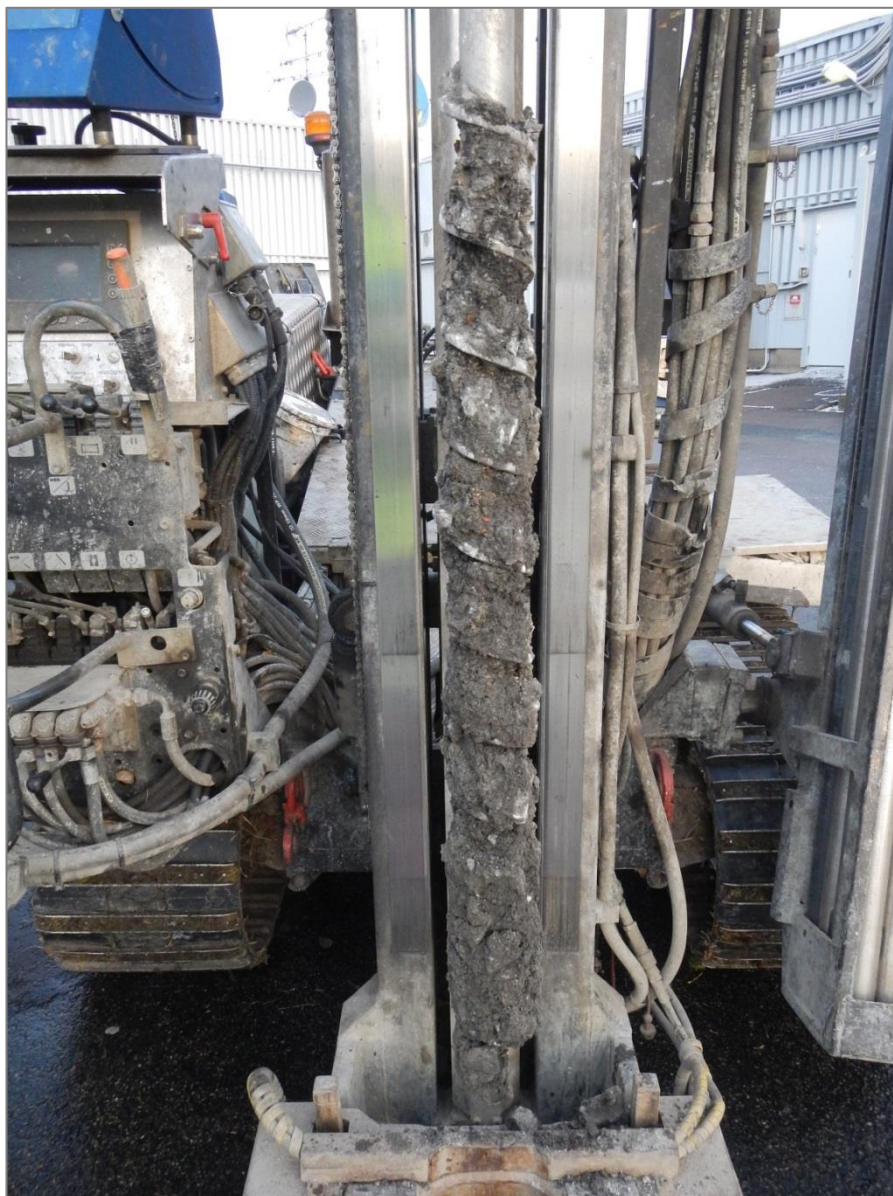
Figur 4. Skruvborrning i punkt R1611, 8 november 2016.
