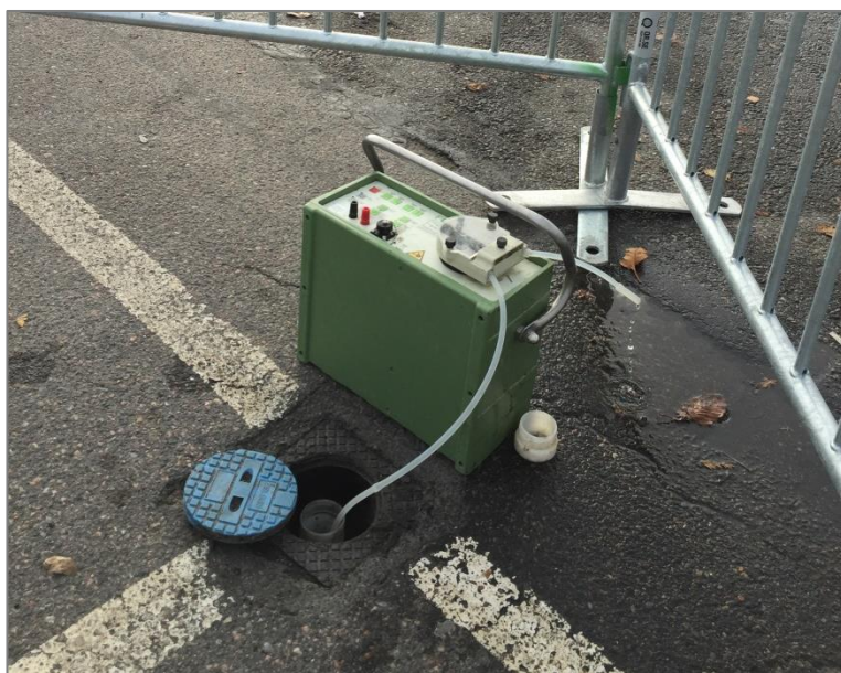
Figur 6. Rensumpning av grundvattenrör GA003.
